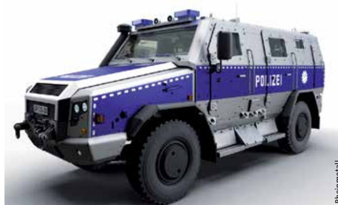
➤ Die Firma Rheinmetall MAN Military Vehicle (RMMV) hat bereits vor Monaten einen serienreifen Demonstrator auf einem handelsüblichen MAN-Lkw-Fahrgestell vorgestellt, der den genannten Anforderungen komplett gerecht wird.
